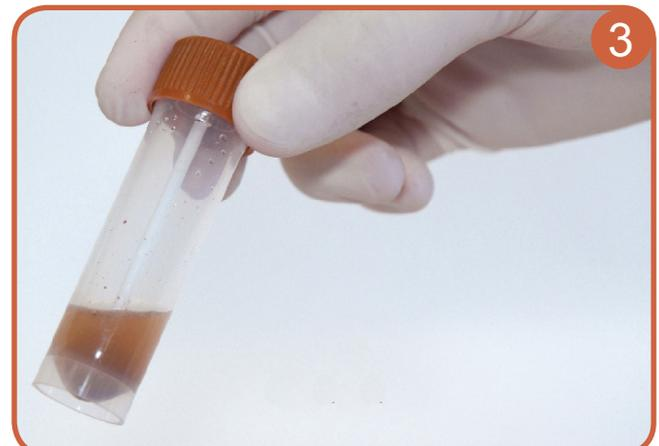
3. Diluez le prélèvement dans le liquide contenu dans le flacon.
